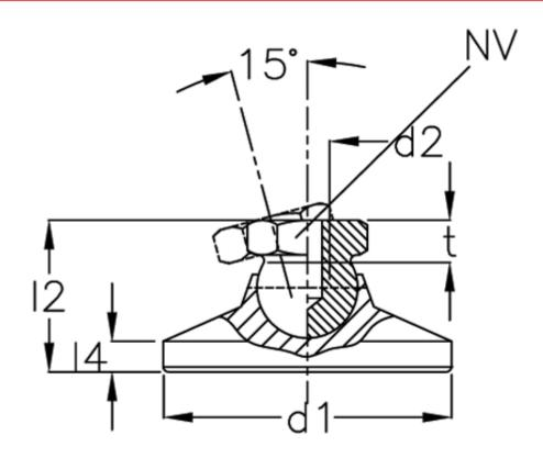
d1 = 50 d2 = 12 l2 = 28 l4 = 7 NV = 17 Static load (kN) = 33 t min = 11.5
